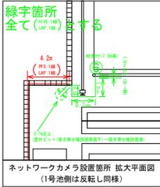
ネットワークカメラ設置箇所 拡大平面図 (1号池側は反転し同様)
